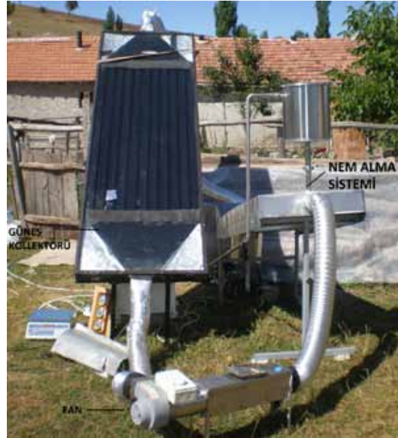
Resim 1. Güneş enerji destekli bal nem alma cihazı.
